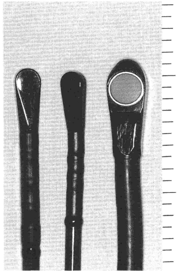
図9 マルチプレーン経食道心エコープローブ 左から Aloka 社製7mm, vingMed 社製7mm, Agilent Technology 社製10mm
